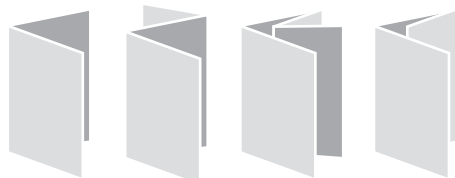
Einfachfalz, Zickzackfalz, doppelter Parallelfalz und Wickelfalz.
